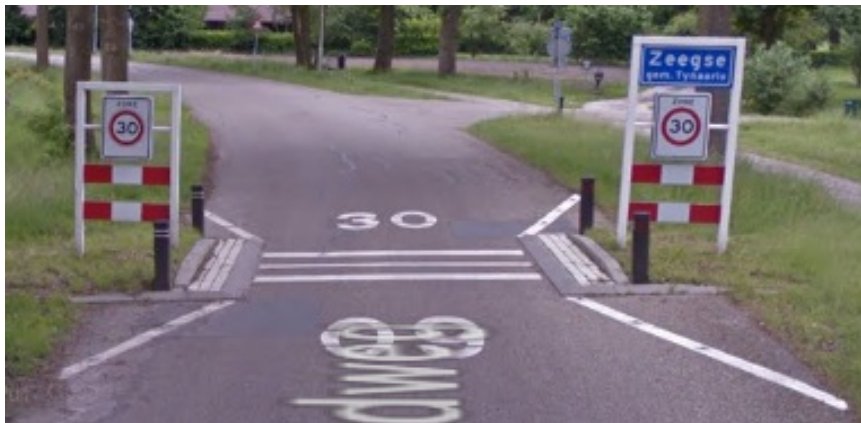
Foto: voorbeeld komversterking gecentreerde versmalling
